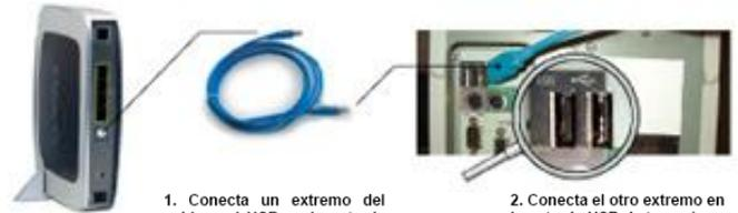
1. Conecta un extremo del cable azul USB en la entrada azul del Módem.
