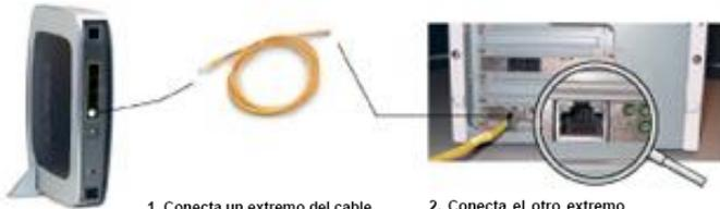
1. Conecta un extremo del cable amarillo Ethernet al en la entrada amarilla del Módem
